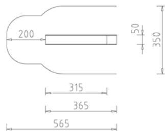
Beschreibung: Anbaurutsche mit Einsitzteil, Rutsche und Auslauf aus Edelstahl, Einstiegswangen 55 cm hoch, Werkstoff 1.4301 V2A, Blechstärke 2 mm, geschweißte Ausführung.
