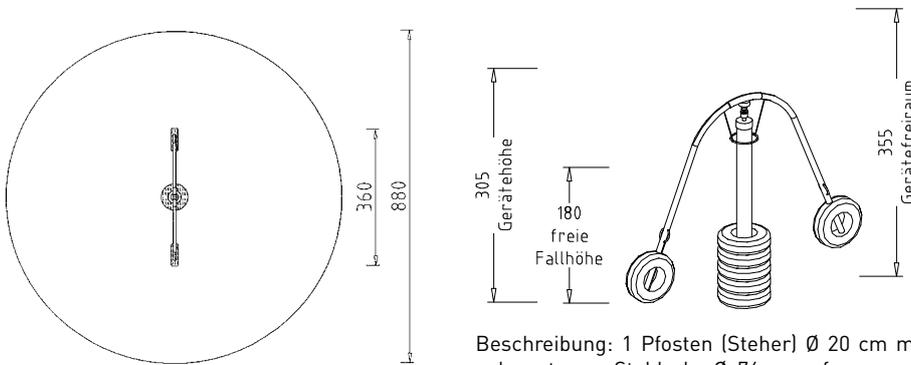
Beschreibung: 1 Pfosten (Steher) Ø 20 cm mit Kern, hufeisenförmiger Wippbalken, drehbar gelagert, aus Stahlrohr Ø 76 mm, feuerverzinkt, mit Kardangeln-Lagerung, 2 Sitzreifen, 4 Haltegriffe, 6 Dämpfungsreifen, über den Mast gestülpt, am Boden aufliegend. Die Zierelemente für Drehwippe, lt. Abbildungen Best.Nr. 963010 bis 963040, sind gegen Aufpreis lieferbar. Aufständering mit 1 Stk. Vierfachlasche.
